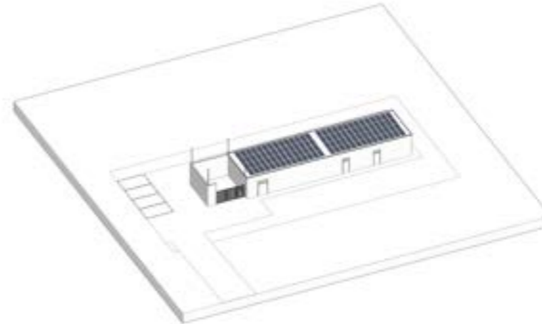
3.37 Zonnepanelen toepassen op het dak van het verdeelstation.
